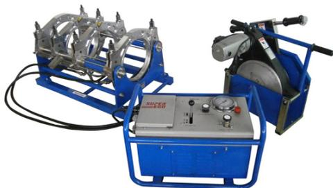
Сварочная машина отлично подходит для сварки пластиковых труб из ПЭ, ПП и ПВХДФ диаметром до 315 мм при монтаже водопроводов.
