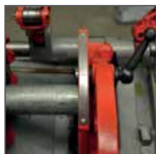
Регулировка глубины нарезки резьбы.
